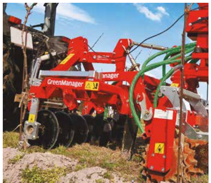
Le cultivateur passe sous la végétation sans mélanger la terre. Le sol reste recouvert : économie d'eau et protection contre l'érosion !
